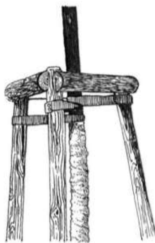
Obr.: Úvazky k uchycení stromu ke kůlům
